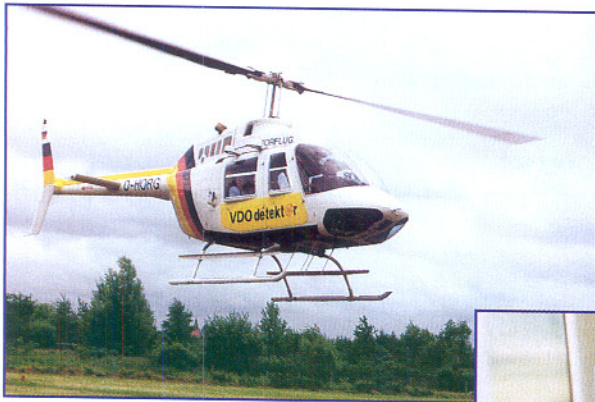
Bild 4: Auch per Hubschrauber kann eine direkte Peilung und Verfolgung realisiert werden. Seine Vorteile: schneller, beweglicher, geländeunabhängig und nicht an Fahrwege gebunden.
