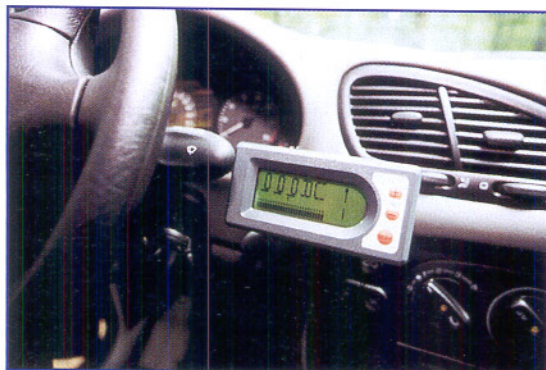
Bild 5: Das Display des Peilgerätes zeigt die Richtung und die Feldstärke an, es erinnert etwas an ein Navigationssystem.
